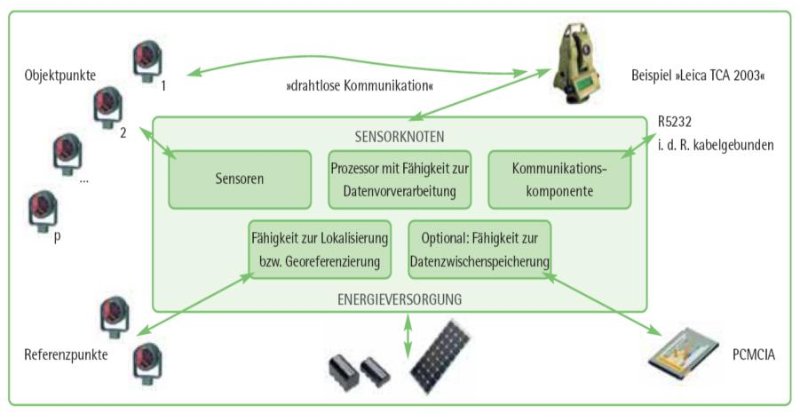
Abb. 3: Motorisiertes Tachymeter als Sensorknoten bei Überwachungsaufgaben
